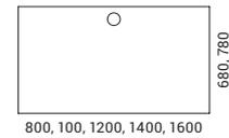
**ATTENTION ! Ce type de plan de travail n'est compatible qu'avec des écrans latéraux de 824 mm de largeur (680/780)**
